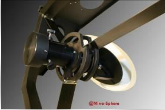
Support secondaire sur rotule, permettant de garder l'offset, branche carbone.
